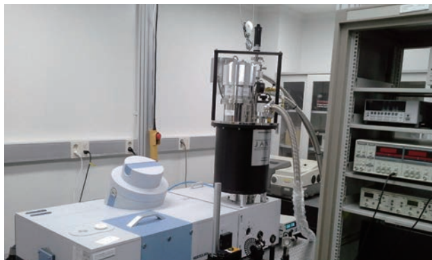
극저온 중적외선 측정 시스템
