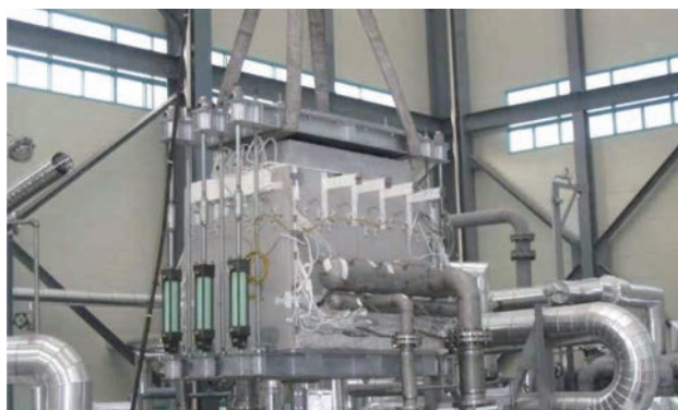
용융탄산염 연료전지 스택 및 시스템 제작
