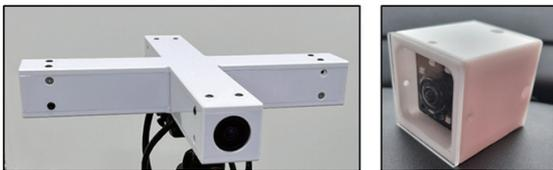
그림 3-2 360도 전방위 다채널 카메라 시스템
