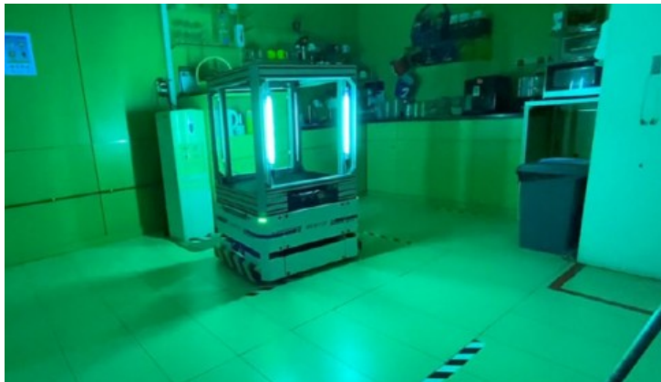
그림 37. 세스토 로보틱스의 24시간 소독 및 방역 활동이 가능한 모바일 살균 로봇
