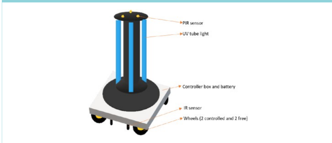
그림 38. 자외선 로봇(UV Robot)의 디자인
