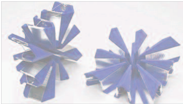
그림 5. 정전식 latch는 동일한 모양끼리 요철에 맞춰 결합된다. 나사와 달리 암수 구분이 없다[8].
