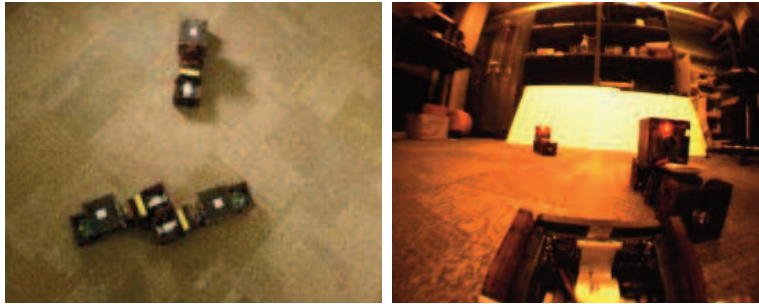
그림 12. Ckbot의 형상에 따른 이동방식 구르기, 걷기, 바퀴이용[13]
