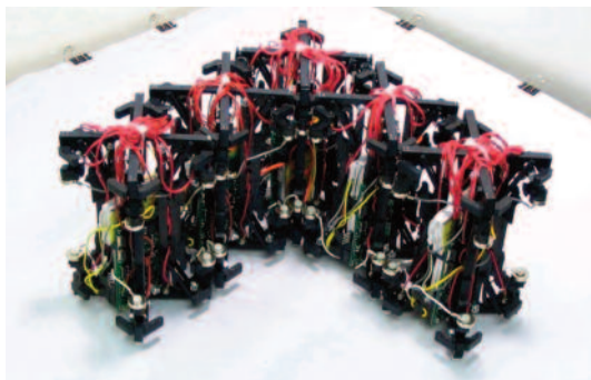
그림 13. 외력을 이용한 재배열. 아래 판이 조건에 맞게 회전하고 판 위에 있는 로봇에 생기는 원심력으로 배열을 바꾼다[15].
