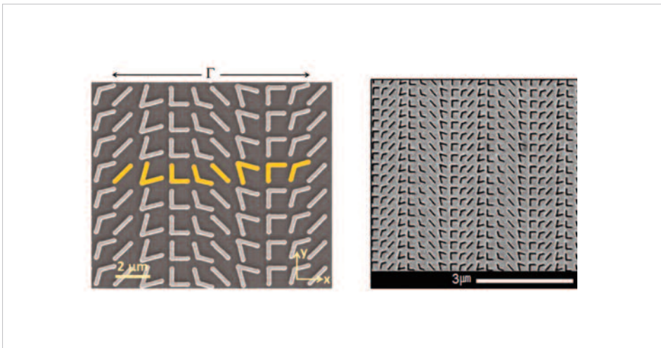
그림 22. 5-10 \mu\text{m} 영역과 1.0-1.5 \mu\text{m} 영역에서 일반화된 굴절법칙을 보이는 양각과 음각으로 만든 메타물질 22,23 .
