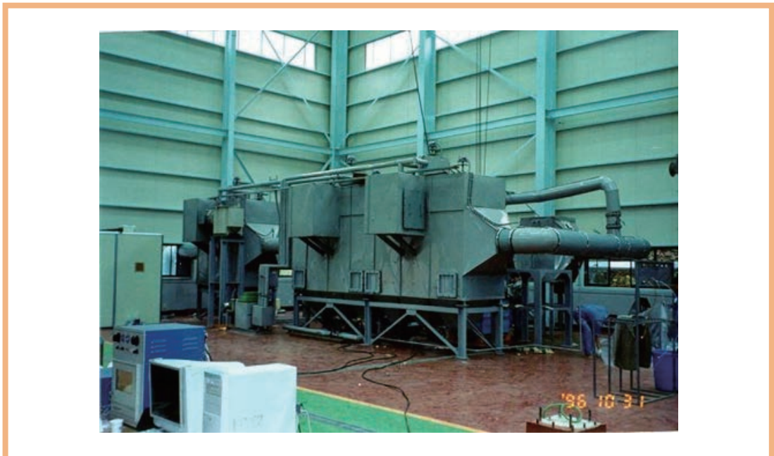
그림 12. 펄스 코로나를 활용한 탈황탈질 파일럿 플랜트, (출처: 기계연구원 제공)
