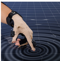
CyberGlove System사의 CyberGlove (데이터 글러브의 손가락 부분에 진동자가 장착되어 있고, 손가락이 가상 물체를 만지면 적절한 진동을 발생시킴)
