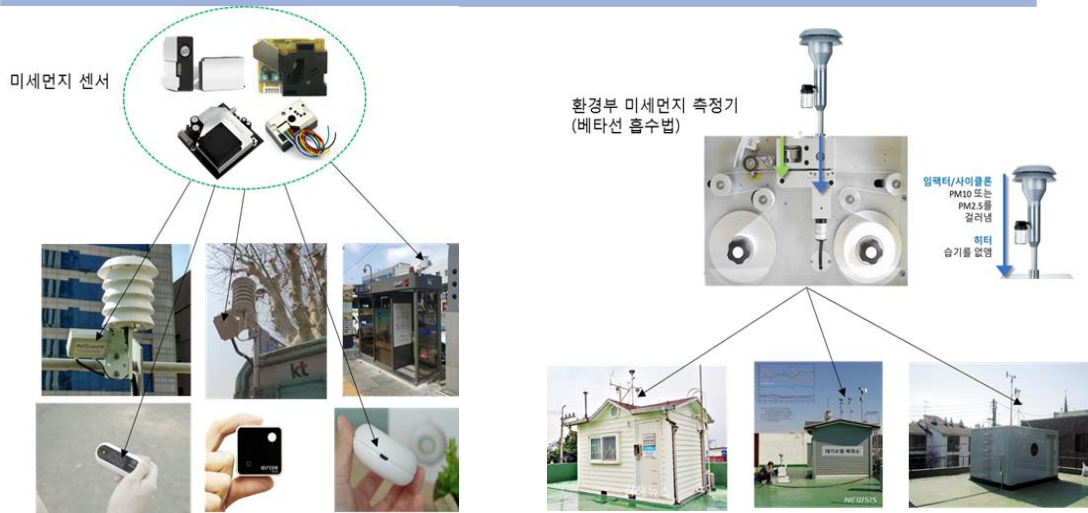
그림 2 기존 IoT기반 미세먼지 센서와 대기오염 측정망 형식승인 장비인 베타선 흡수법 측정기
